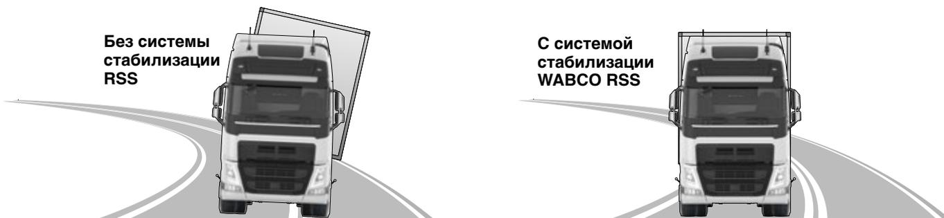
Система стабилизации и предотвращения опрокидываний Rollover Stability Support (RSS) является стандартной функцией Trailer EBS и помогает водителю лучше контролировать автопоезд.
